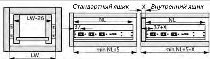
Установочные размеры (корпус ящика)
