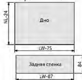
Раскрой плиты 16 мм
